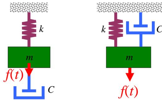
圖二 簡化之質點-彈簧-阻尼系統
