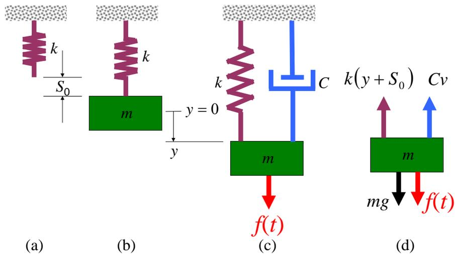
圖三 (a)彈簧未伸長；(b)彈簧產生靜態伸長量 $S_0$ ；(c)彈簧產生動態伸長量  $y$ ；(d)以牛頓第二運動定律分析質量為  $m$  之物體的運動行為
